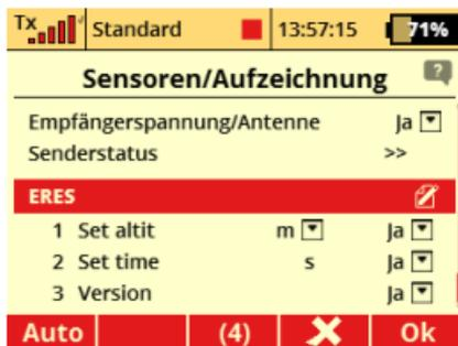
Um die Telemetrieparameter korrekt anzuzeigen, muss die Sensortelemetrie neu geladen bzw. zurückgesetzt werden. Wählen Sie im Menü Stoppuhren / Sensoren -> Sensoren / Aufzeichnung die Option Auto (Taste F1 links unter dem Display).
