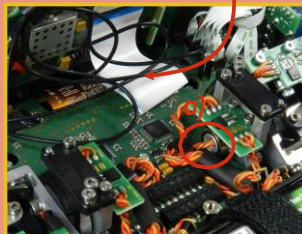
正确布置显示器扁平，柔性电缆。
