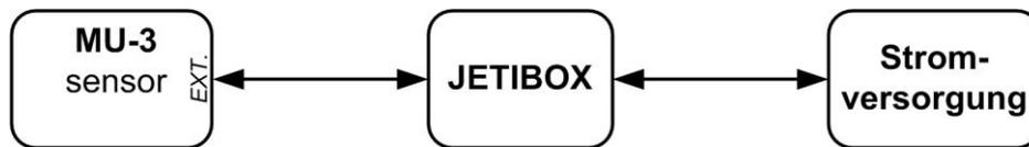
2. Schließen Sie das dreiadrige Kabel des Moduls MU-3 mit JR-Stecker an die Buchse des DUPLEX-Empfängers an seiner Rückseite an (Bezeichnung Ext.). Der Sensor MU-3 wird vom Empfänger mit Strom versorgt. Zur Parametereinstellung des Sensors MU-3 schließen Sie die JETIBOX an das Sendermodul an und schalten den Empfänger und Sender DUPLEX ein.
