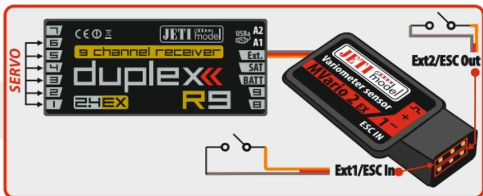
Fig. 7: MVario2 angeschlossen am "Ext." Anschluss des Empfängers zur Erfassung logischer Zustände und deren Telemetrieübertragung
