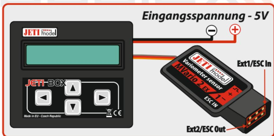
Fig. 1: Anschluss des MVario2 direkt an die JETIBOX
