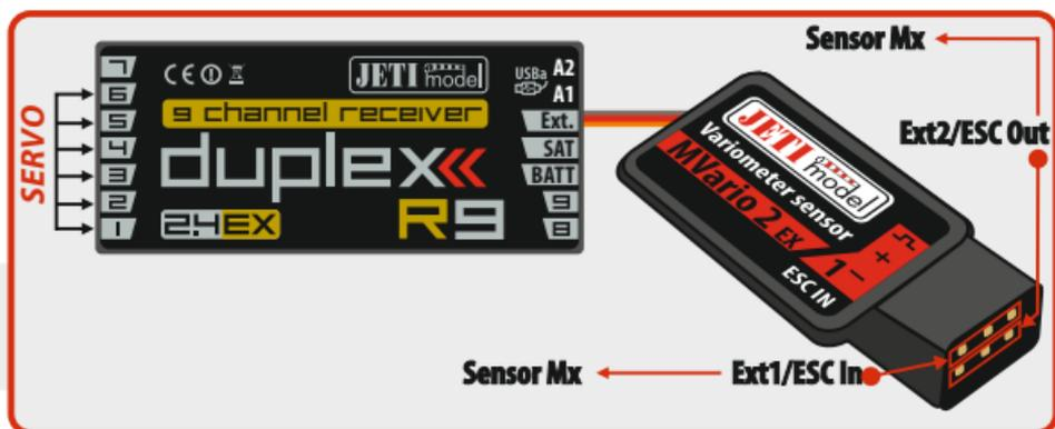
Fig. 4: MVario2 arbeitet als Expander für weitere Sensoren
