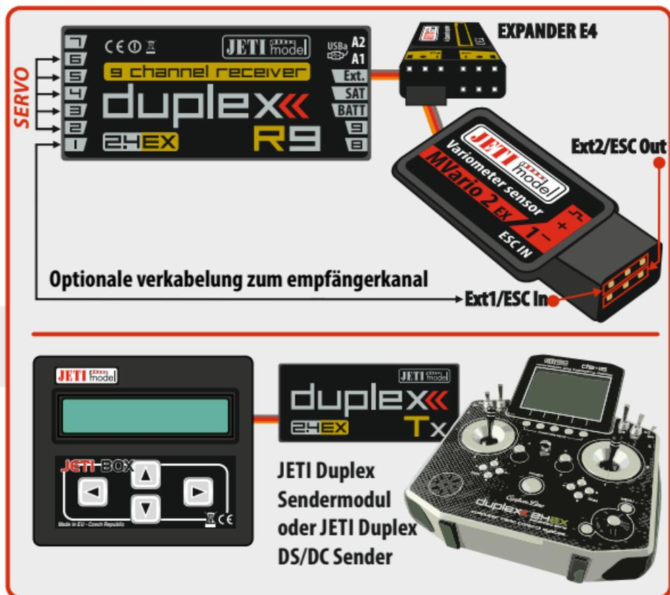
Fig. 3: MVario2 über einen Expander angeschlossen
