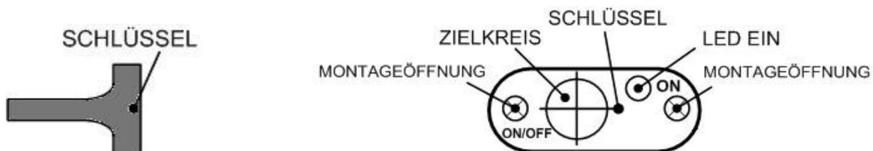
Bei Anlegen des Magneten in Schlüsselposition leuchtet die grüne LED nach einem Zeitintervall von 1s dauerhaft auf und der Elektronikschalter ist somit eingeschaltet. Das Ausschalten läuft analog ab, nach Wiederanlegen des Magneten geht nach etwa 1s die grüne LED aus und das System ist abgeschaltet.
