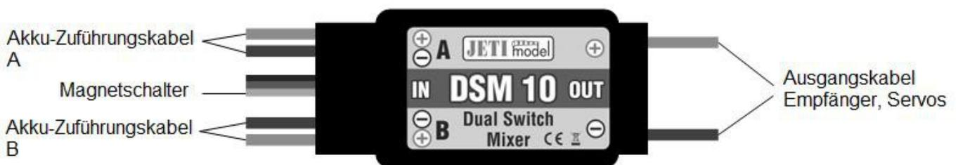
Achten Sie auf den richtigen Anschluss der Eingangs- und Ausgangsleiter, wobei Kabel mit rotem Schrumpfschlauch zum Anschluss an den Pluspol und Kabel mit schwarzem Schrumpfschlauch an den Minuspol dienen.
