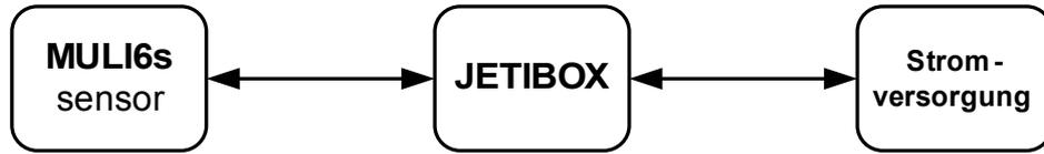
2. **direkt an den Empfängereingang (Ext.).** Bei dieser Schaltung ist es möglich jeden Sensor MULi6s zu verwenden, der aus dem Empfänger versorgt wird.
