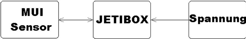
2. **direkt an den Empfängereingang (Ext.).** In diesem Fall kann nur ein Sensor angeschlossen werden. Der Sensor wird vom Empfänger mit Strom versorgt.
