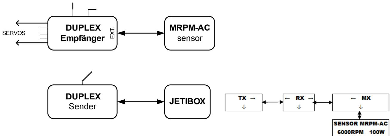
3. **Anschluss über einen Expander Ex.** In diesem Fall können die Daten von mehreren Sensoren gleichzeitig verarbeitet werden (je nach Expandertyp). Das Modul MRPM-AC wird vom Expander mit Strom versorgt.
