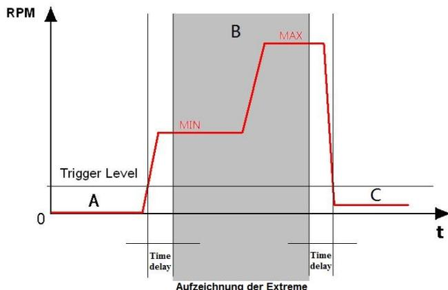
B – der aktuell gemessene Drehzahlwert hat den *Trigger level* für eine längere Zeit, als den eingestellten *Time delay* überschritten. Die vorhergehenden Messwerte (*RPM MIN / MAX*, *POWER MIN / MAX*) werden automatisch gelöscht und werden durch die gerade ablaufende Messung aktualisiert.
