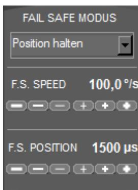
Hier können Sie wählen, wie sich das Servo bei Wegfall der Servoimpulse vom Empfänger verhalten soll. Dieser Modus wird nur bei einer Unterbrechung des Signalkabels aktiv oder wenn der Empfänger bei aktiven Fail-Safe keine Servoimpulse mehr ausgibt).
