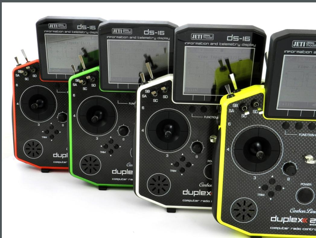
Die DC/DS 16 Color Carbonline Sender werden auch in verschiedenen Farbvarianten angeboten. Die Aluminiumrahmen dieser Sender wurden mit einer sehr hochwertigen Lackierung und anschließendem Klarlacküberzug versehen. Diese Sender sind auch mit den sogenannten „Multimode“ Knüppelaggregaten ausgerüstet und erlauben einen einfachen Wechsel zwischen den verschiedenen Steuermodi.
