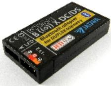
RCDroid BOX DC/DS – speziell für Duplex DC/DS Sender
