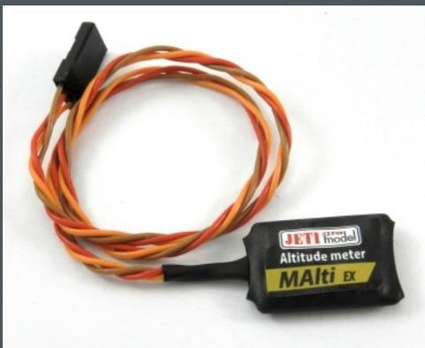
Das MAlti EX ist ein Sensor, der den atmosphärischen Druck misst. Aus den gemessenen Daten errechnet das MAlti EX die Höhe über NN und die relative Höhe über Grund. Ausserdem werden die minimalen/maximalen Daten erfasst und der Sensor kann Warnungen für gesetzte Grenzwerte ausgeben. Die Daten des Sensors werden über das Duplex-System an den Benutzer übertragen und die tatsächlichen Messwerte in Echtzeit auf dem LCD-Bildschirm der JETIBOX oder auf den JETI model DC/DS-Sendern angezeigt.
