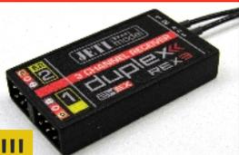
DUPLEX-Empfänger sind für den Betrieb mit DUPLEX Sendern und DUPLEX Sendemodulen bestimmt und arbeiten im 2,4 GHz-Band. Dank der digitalen und bidirektionalen Kommunikation zwischen Sender und Empfänger werden neue Möglichkeiten im Bereich der Modell-Fernsteuerung eröffnet.
