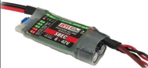
mit 2S bis zu 12S Li-XX Zellen. Die Einstellung der Ausgangsspannung im Bereich von 5 bis 8 V geschieht mit Hilfe von Jumpers. Das bedeutet, dass der SBEC auch für die Anwendung neuer Servos mit „erhöhter“ Spannung vorbereitet ist.
