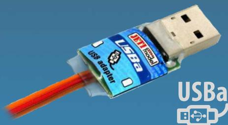
Der USB Adapter ist die Schnittstelle zwischen dem PC und allen mit dem "USB-Support" Logo versehenen Jetiprodukten. Der Anschluss erfolgt am USB-Port des PCs und der Sensorbuchse "EXT".
