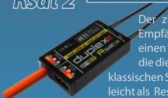
Der zusätzliche Satellitenempfänger RSat2 dient zur Ergänzung der Empfänger R9, R10, R11EPC, R12EPC, R14 und R18. Es handelt sich um einen vollwertigen Empfänger des Systems DUPLEX mit allen Funktionen, die dieses System bietet. Der Ausgang des Empfängers RSat2 liefert keine klassischen Servoimpulse, sondern ein PPM-Signal und man kann ihn deswegen leicht als Reserveverbindung zu den oben genannten Empfängern verwenden.
