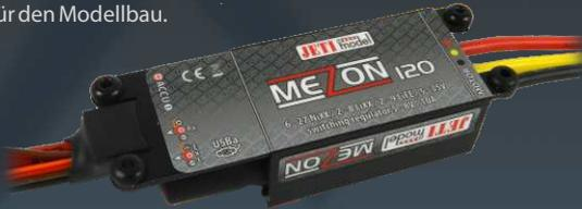
Die Controller ermöglichen eine sehr genaue Strommessung gesondert im BEC-Stromkreis, sowohl auch den Gesamtstrom durch den Controller. Infolgedessen kann die entnommene Kapazität des Akkus gemessen werden und nicht nur die Abschaltspannung eingestellt werden, sondern auch die zulässige entnommene Kapazität. In Verbindung mit den Empfängern DUPLEX bieten sie selbstverständlich eine große Anzahl weiterer Möglichkeiten bei der Verfolgung von Flugparametern und bei der Analyse von Flugdaten..
