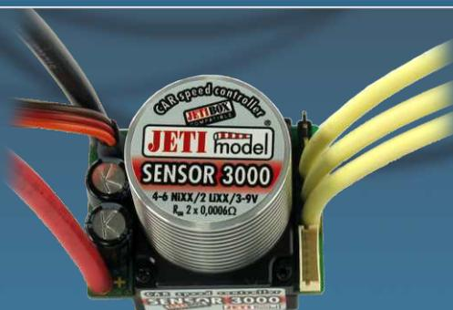
Der Controller CAR Sensor 3000 ist für die Steuerung von bürstenlosen Motoren (BLDC) mit SENSOREN (z.B. Hall- oder optische Sensoren zur Lagererkennung des Ankers) und für Gleichstrommotoren (DC) geeignet. Der Controller erkennt den Typ des angeschlossenen BLDC-Motors, die Sensorausstattung und die mechanische Einstellung der „Vorzündung“, dadurch können Antriebe verschiedener Hersteller und unterschiedlicher Typen angeschlossen werden.
