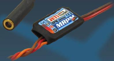
Der Sensor MRPM dient zur Drehzahlmessung bei Modellen mit Luftschraube. Die Messung selbst wird beim Modul MRPM durch einen optischen Sensor bewerkstelligt, der die Anzahl der Unterbrechungen eines Lichtstrahls durch die Luftschraube pro Minute auswertet. Der Sensor MRPM misst die aktuelle Drehzahl, die Luftschraubenleistung, zeichnet weiterhin Extreme auf und warnt bei Überschreitung voreingestellter Parameter. Die Informationen vom Sensor werden durch das DUPLEX-System zum User übertragen.
