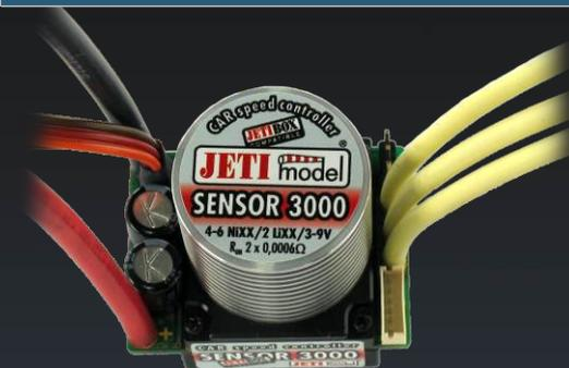
Der Controller CAR Sensor 3000 ist für die Steuerung von bürstenlosen Motoren (BLDC) mit SENSOREN (z.B. Hall- oder optische Sensoren zur Lagererkennung des Ankers) und für Gleichstrommotoren (DC) geeignet. Der Controller erkennt den Typ des angeschlossenen BLDC-Motors, die Sensorausstattung und die mechanische Einstellung der „Vorzündung“, dadurch können Antriebe verschiedener Hersteller und unterschiedlicher Typen angeschlossen werden.
