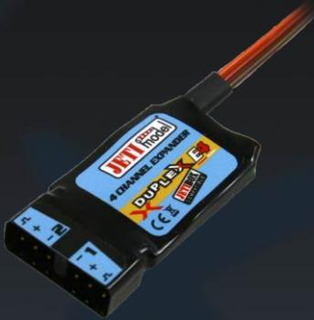
Der Expander E4 ist ein Erweiterungsmodul des telemetrischen Systems DUPLEX 2,4 GHz. An einen DUPLEX-Empfänger können bis zu 4 telemetrische Sensoren angeschlossen werden. Dank der Eigenschaften des Expanders können gleichzeitig Daten mehrerer telemetrischer Sensoren überwacht werden einschließlich der eingestellten Alarme. Zur Darstellung der gemessenen Werte wird das Terminal JETIBOX mit der Möglichkeit drahtloser Informationsübertragung über das System DUPLEX 2,4GHz genutzt.
