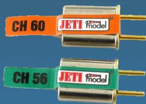
Wir empfehlen die Verwendung von originalen JETI model Quarzen in Verbindung mit JETI REX Empfängern.
